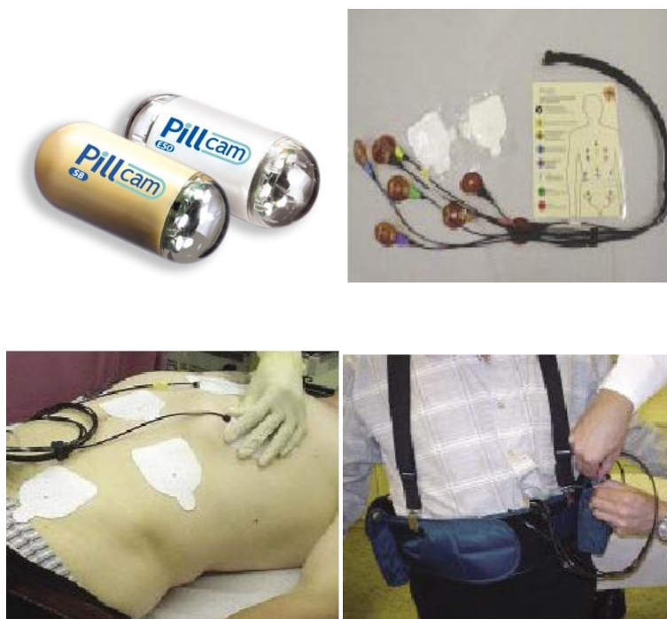
Figura 1. Sistema diagnóstico Given®. Consta de una cápsula M2A, un registrador ambulatorio y un programa para el procesamiento y evaluación de las imágenes
