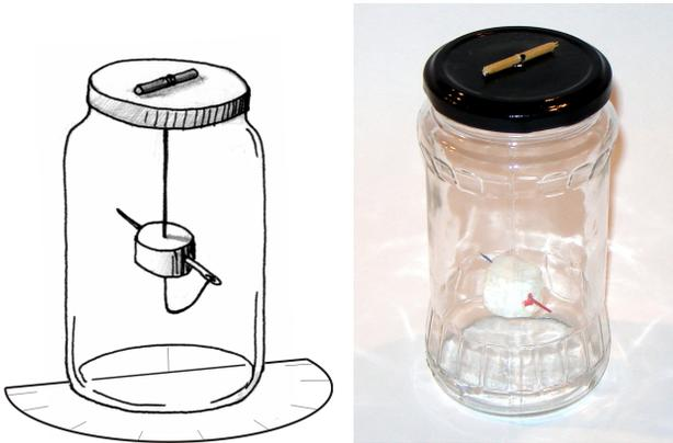
Figura 1.4: Frasco con brújula. Esquema y foto (en la foto se ha omitido el transportador).
