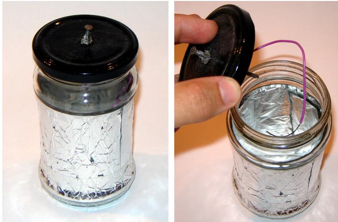
Figura 2.3: Modelo del condensador y detalle interno.
