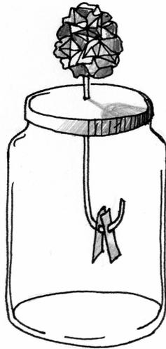
Figura 2.1: Equema del electroscopio.
