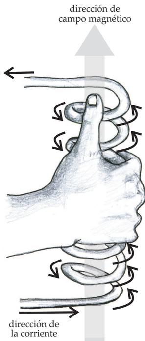
Figura 3.1: Regla de la mano derecha: si se dispone la mano derecha de modo que los dedos índice, mayor, anular y meñique señalen el sentido de la corriente (por ejemplo, tomando imaginariamente la bobina), entonces el pulgar extendido señalará la dirección del campo magnético.
