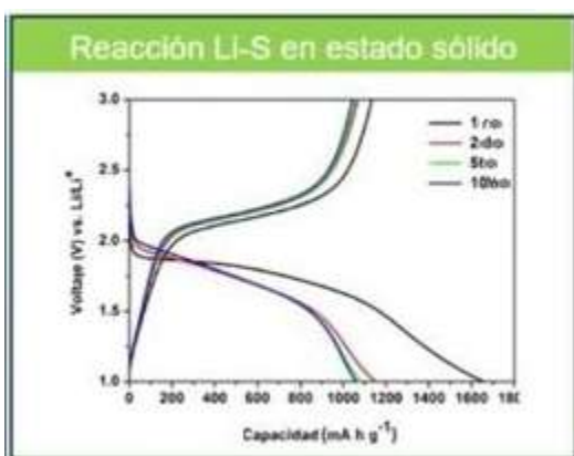
Figura 5. Reacciones en celdas de litio-azufre con \text{S}_{1-3} nanoconfinado. Adaptado de [66].
