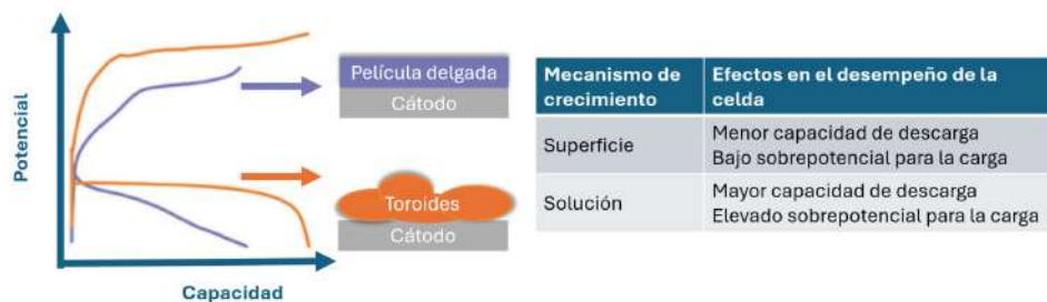
Figura 6. Comparación en el comportamiento de la celda de \text{Li-O}_2 según el mecanismo de crecimiento. Adaptado de [9].
