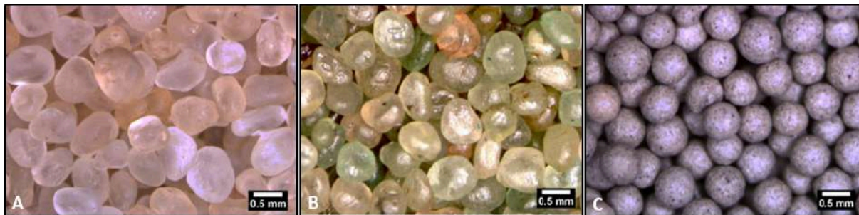
Figura 3. Tipos de agentes de sostén. A) arenas naturales. B) arenas resinadas. C) artificiales.
