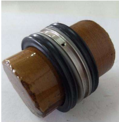
Figura 5: Paquete de ensayo formado por un plug y el par de O-rings.
