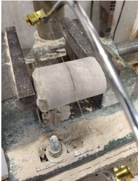
Figura 2: Terminación de entalla con hilo diamantado.
