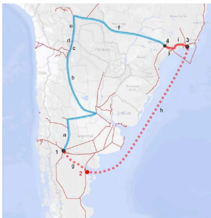
Figura 1. Alternativas de transporte evaluadas. Ruta de gasoductos: color azul. Ruta GNL: color rojo. 1: Tratamiento de gas, Neuquén (AR). 2: Nuevo puerto y planta de licuefacción en Punta Colorada, Río Negro (AR), 3: Terminal GNL y planta regasificadora, Río de Janeiro (BR), 4: nodo Paulínia, São Pablo (BR). a: gasoducto del centro, b: gasoducto del norte, c: gasoducto Campo Durán, d: gasoducto Juana Azurduy, e: gasoducto Yacuiba – Río Grande, f: gasoducto Transboliviano, g: nuevo gasoducto a Punta Colorada (traza estimada), h: ruta marítima GNL, i: gasoducto Japerí, j: gasoducto Paulínia.
