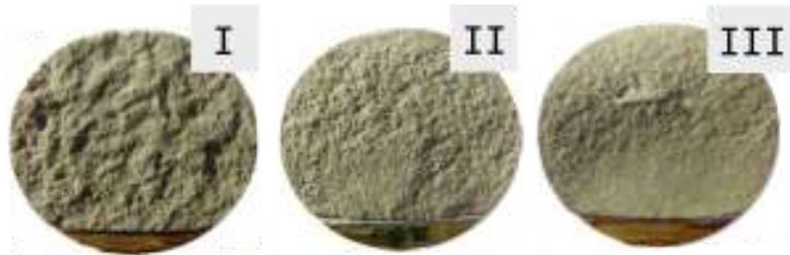
Figura 19: Evolución de la superficie de fractura frente a la presión de confinamiento. Las notaciones I, II y III corresponden a la condición atmosférica, 20 MPa y 50 MPa respectivamente.
