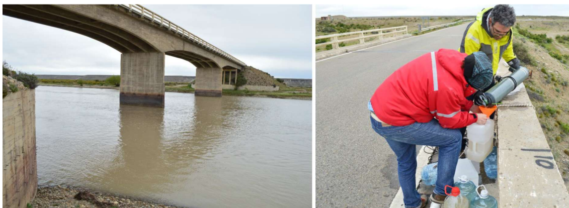
Figura 2.35: Puente de la RN3 sobre el Río Chico. Fotografía del flujo tomada desde margen izquierda (izq.), y recolección de la muestra de agua de botella Niskin de 8 lts. (der.).
