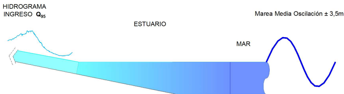
Figura 5.9: Representación esquemática de las condiciones de contorno para el escenario de caudales pobres: hidrograma Q_{95} ingresante al estuario desde el río Santa Cruz y variación de niveles producto de la marea media aguas abajo
