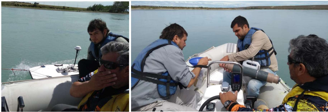
Figura 2.33: Aforo líquido con ADCP y sólido con botella Niskin en Puente Viejo.
