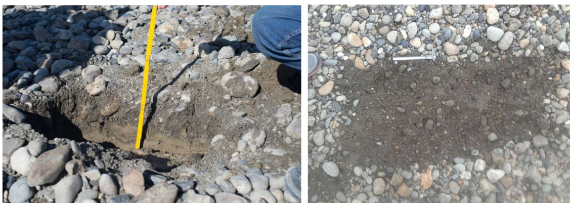
Figura 2.5: Fotografías representativas del acorazamiento observado en el río Santa Cruz. Corresponden a los sitios Charles Fuhr (izq.) y Puente Viejo (der.)
