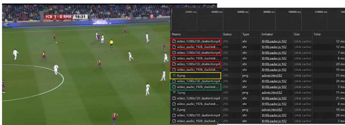
Fig. 12. Contenido multimedia a una resolución de 1280x720 y bitrate de 2400 kbps
