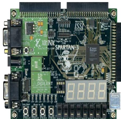
Figura 3. Spartan 3 Starter Board con una FPGA Spartan 3.
