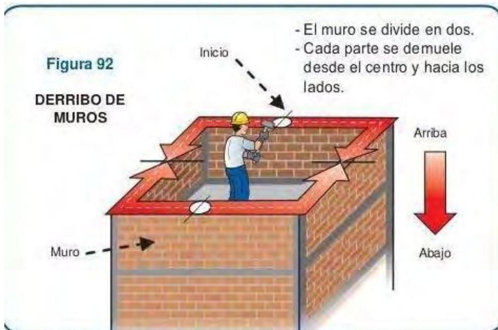
**Imagen de demolición manual de muros.**
