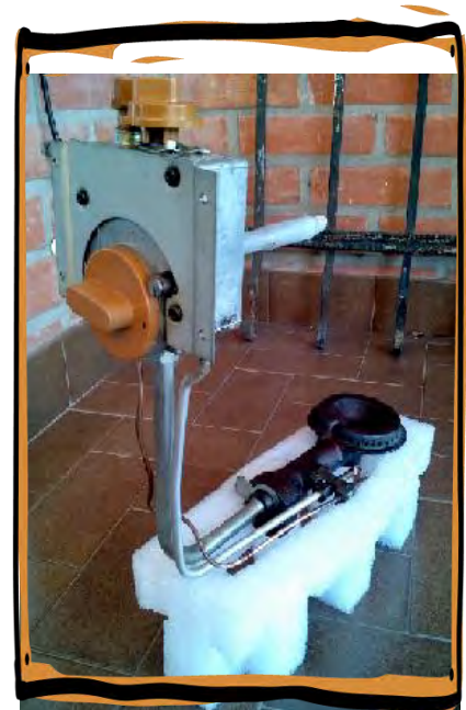
Control de termostato y quemador
