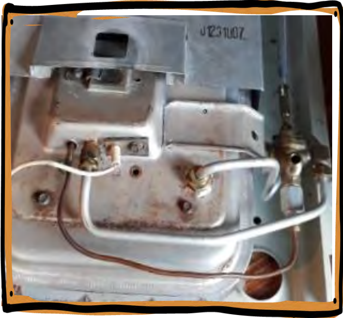
Entrada de gas, piloto, encendido piezoeléctrico Kcal/hora y válvula de seguridad
