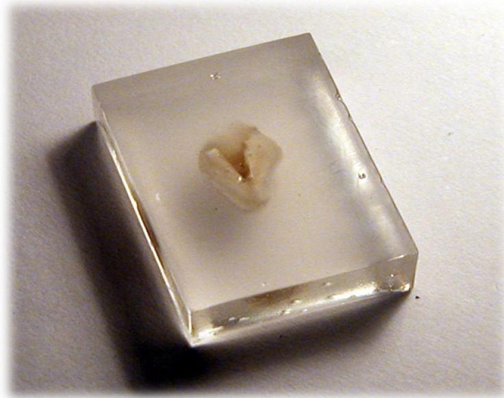
Fig. 1. Muestra incluída en resina epóxica
