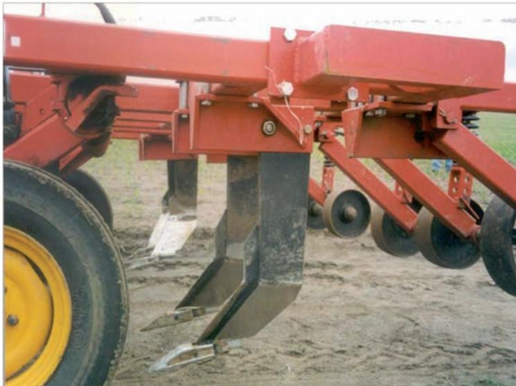
Figura 13. Subsolador para aflojar suelos compactados
