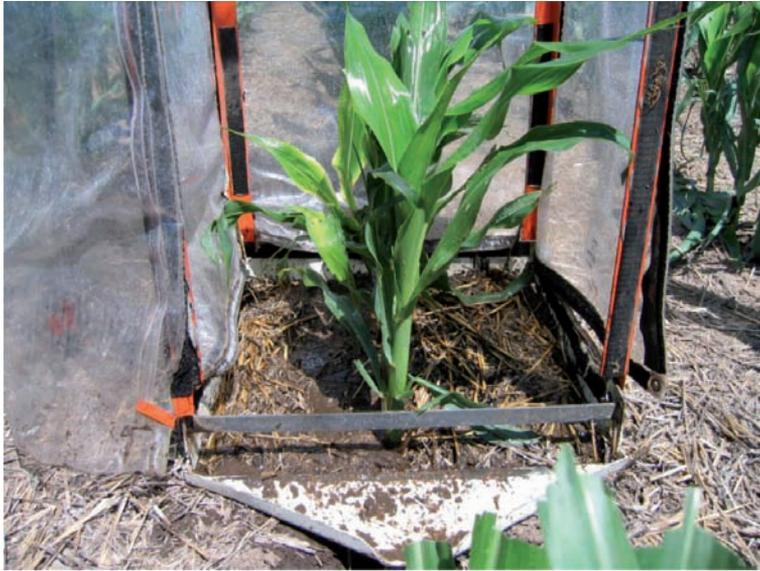
Figura 8. Detalle de la parcela de medición del simulador de lluvia
