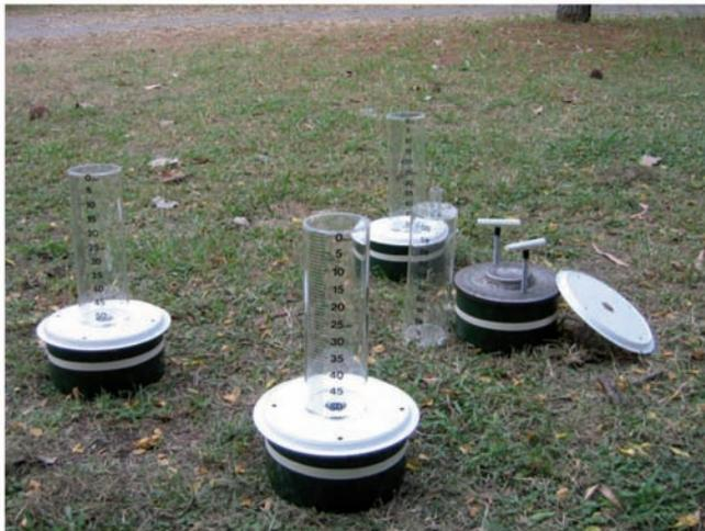
Figura 6. Infiltrómetros de anillo simple construidos en el Instituto de Suelos
