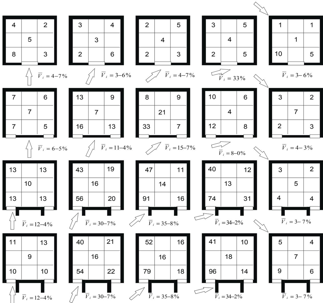
**FIGURA 21:** Variación de la velocidad del aire en el interior de locales en función del ángulo de incidencia del viento y la utilización de pantallas verticales fijas (Givoni, 1969).
